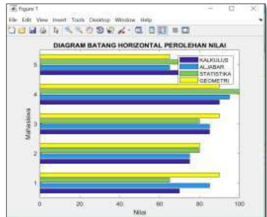
Gambar 5.21. Penggunaan perintah barh(data) untuk membuat diagram batang dari data berkelompok secara horizontal
